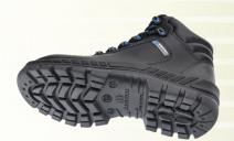
Solado Constituído de duas camadas de poliuretano (PU), injetado diretamente no cabedal, sendo a 1ª camada (entressola) mais macia e leve, com densidade de 0,4g/cm³ proporcionando maior conforto; e 2ª camada (sola) mais compacta com densidade de 0,9 g/cm<sup>3</sup>, resistente a abrasão com sistema antiderrapante constituído de ranhuras especiais de 3mm de altura e 6mm de largura resistencia ao escorregamento em piso cerâmico e piso de aço (Nível SRC).
