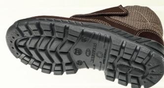
**Solado** Constituído de duas camadas de poliuretano (PU), injetado diretamente no cabedal, sendo a 1ª camada (entressola) mais macia e leve, com densidade de 0,4g/cm<sup>3</sup> proporcionando maior conforto; e 2ª camada (sola) mais compacta com densidade de 1,0 g/cm<sup>3</sup>, resistente a abrasão com sistema antiderrapante constituído de ranhuras especiais de 3mm de altura e 6mm de largura e resistencia ao escorregamento em piso cerâmico e piso de aço (Nível SRC).
