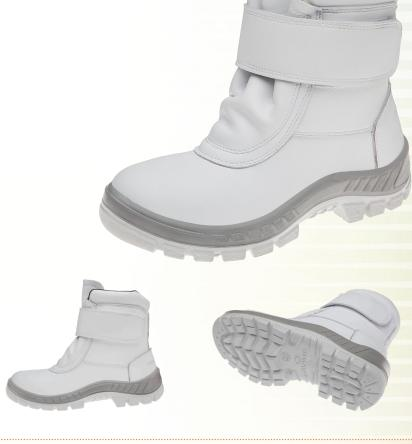
Solado Constituído de duas camadas de poliuretano (PU), injetado diretamente no cabedal, sendo a 1ª camada (entressola) mais macia e leve, com densidade de 0,4g/cm<sup>3</sup> proporcionando maior conforto; e 2ª camada (sola) mais compacta com densidade de 1,0 g/cm³, resistente a abrasão com sistema antiderrapante constituído de ranhuras especiais de 3mm de altura e 6mm de largura e resistencia ao escorregamento em piso cerâmico e
