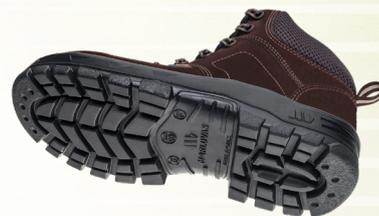
**Solado** Constituído de duas camadas de poliuretano (PU), injetado diretamente no cabedal, sendo a 1ª camada (entressola) mais macia e leve, com densidade de 0,4g/cm<sup>3</sup> proporcionando maior conforto; e 2ª camada (sola) mais compacta com densidade de 1,0 g/cm<sup>3</sup>, resistente a abrasão com sistema antiderrapante constituído de ranhuras especiais de 3mm de altura e 6mm de largura e resistencia ao escorregamento em piso cerâmico e piso de aço (Nível SRC).
